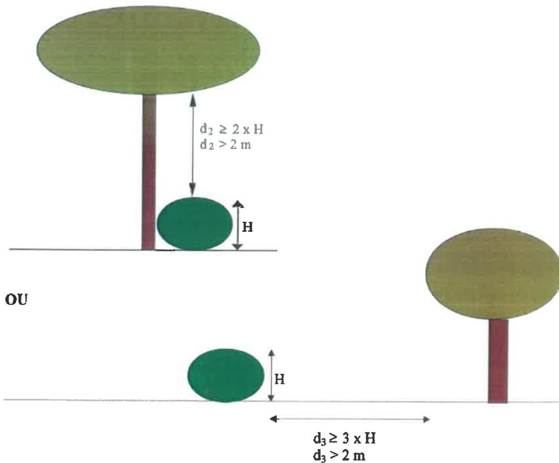
**DISTANCE ENTRE VÉGÉTAUX INFÉRIEURS À 3 MÈTRES ET UNE OUVERTURE OU LA CHARPENTE APPARENTE D'UNE INSTALLATION**
