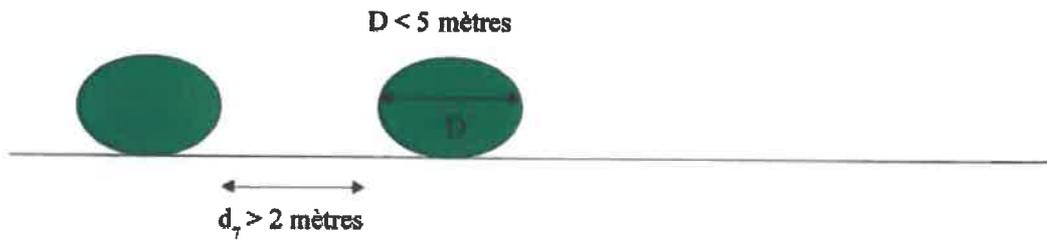
DISTANCE ENTRE VÉGÉTAUX INFÉRIEURS À 3 MÈTRES ET UNE OUVERTURE OU LA CHARPENTE APPARENTE D'UNE INSTALLATION
